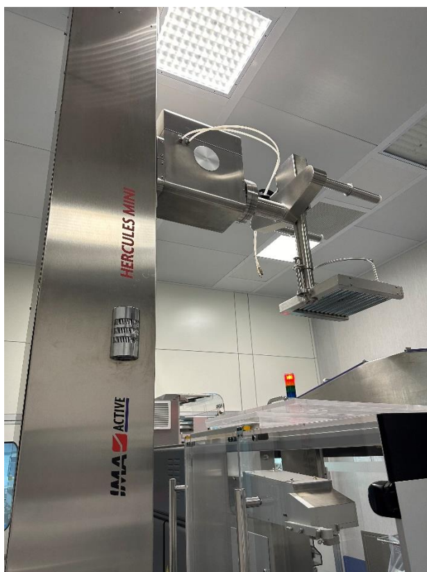
Foto n° 02 – Vista geral do dispositivo de movimentação, modelo HERCULES MINI e fabricante IMA S.p.A (IMA ACTIVE Division) e do seu painel de controle.
