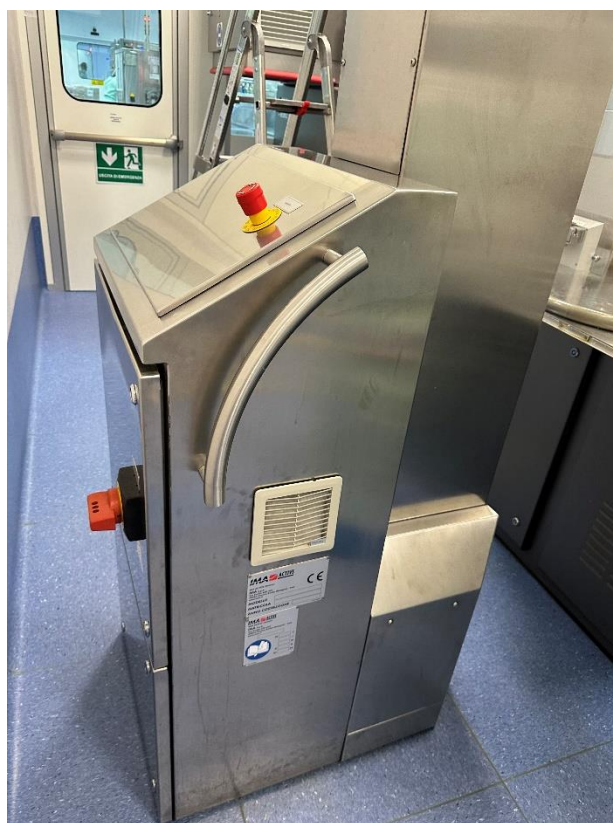
Foto n° 02 – Vista geral do dispositivo de movimentação, modelo HERCULES MINI e fabricante IMA S.p.A (IMA ACTIVE Division) e do seu painel de controle.
