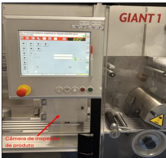
Figura n° 09 – Figuras ilustrativas que mostram a câmera de vídeo e a tela da interface homem-máquina (IHM) dedicada, que são utilizados na inspeção dos medicamentos nos alvéolos (cavidades) do filme do blister.
