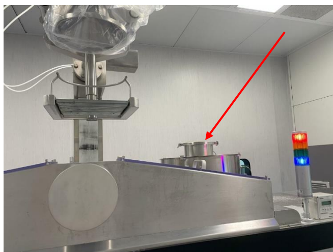
Foto n° 08 – Detalhe da localização do bocal de alimentação de medicamentos.
